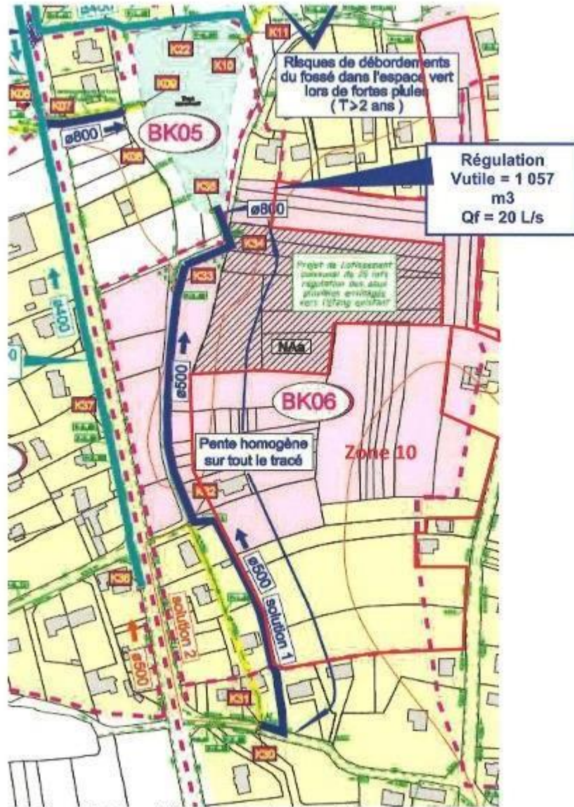
Figure 8 : Scénari d'aménagements – Zone n°10 – Kerbourgneq
